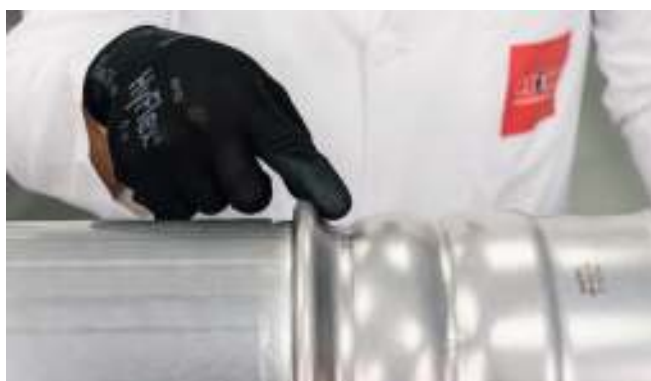
Рис. 36. Визуальный осмотр места прессования Oversize.
